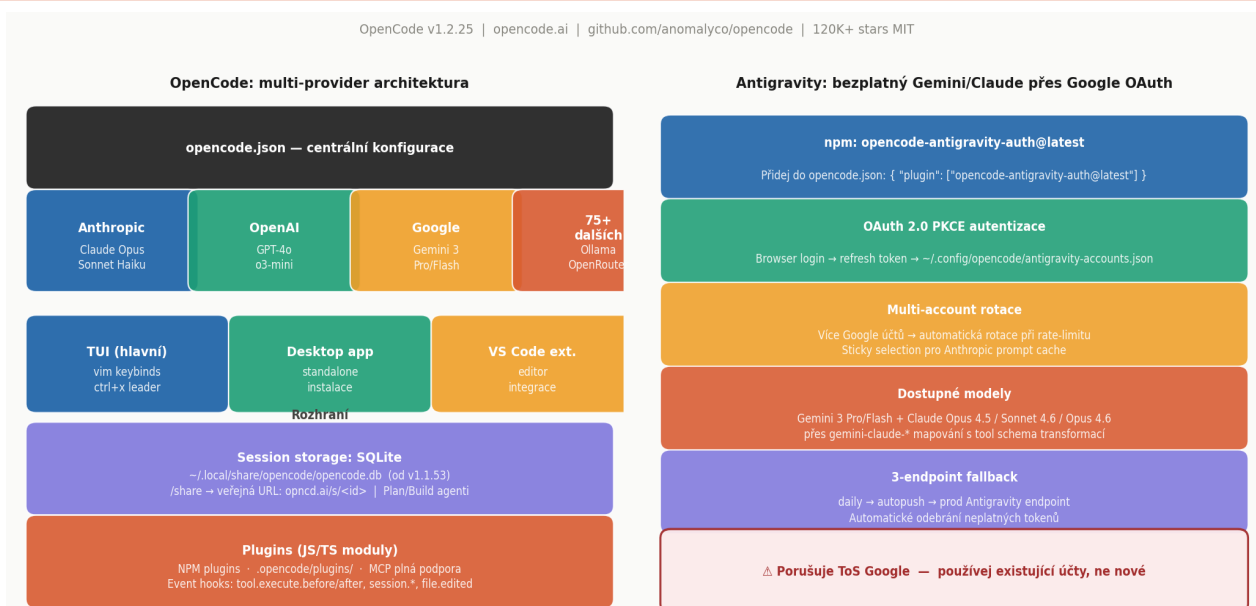
Obr. 7 — OpenCode: multi-provider architektura (75+ poskytovatelů), Plugin ekosystém (JS/TS), SQLite session storage, a Antigravity plugin pro bezplatný přístup k Gemini + Claude.
