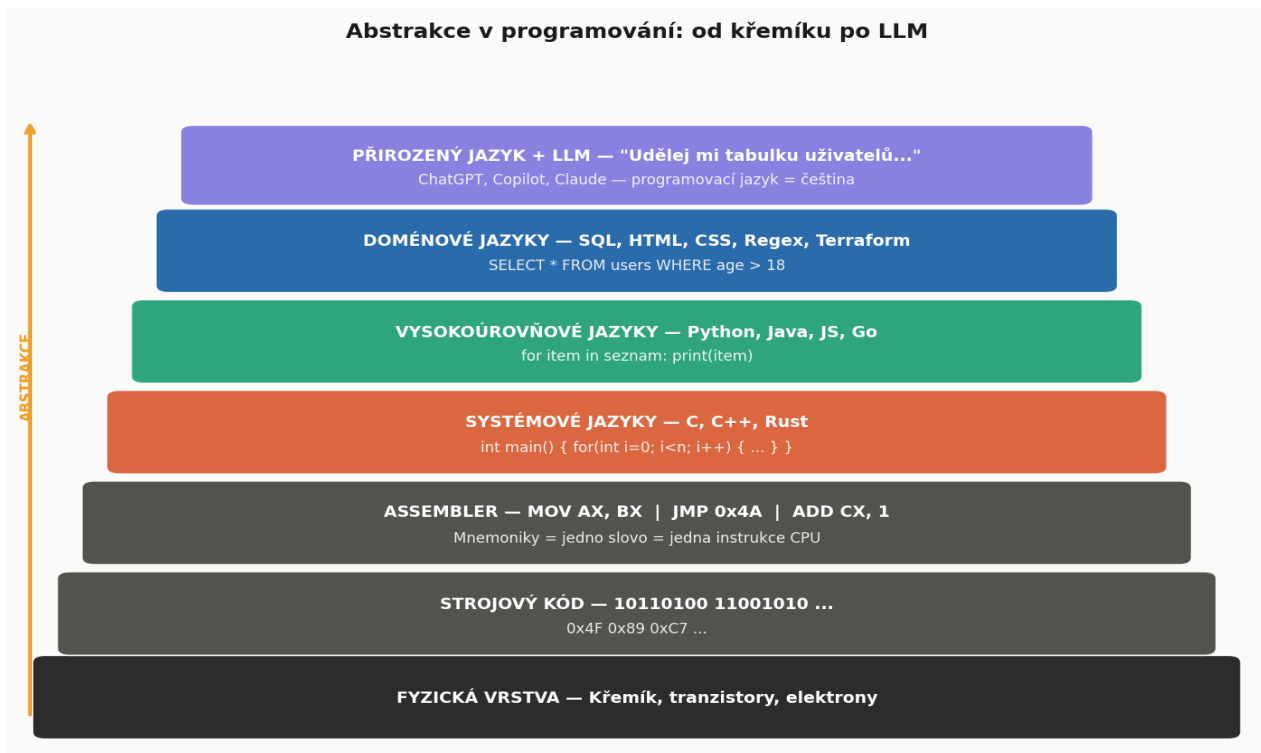
Obr. 4.2 — Abstrakční pyramida: od fyzické vrstvy tranzistorů po LLM. Každá vrstva skrývá komplexitu té pod ní — ale nezruší ji. Porozumění spodním vrstvám odlišuje seniorního inženýra od junióra.
