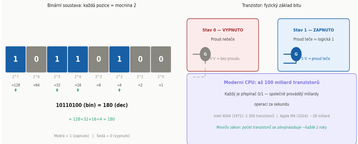
Obr. 1.2 — Tranzistor jako fyzický základ bitu (nahore) a váhový systém binárních pozic: každá pozice = mocnina 2. Moderní CPU: ~28-92 miliard tranzistorů.
