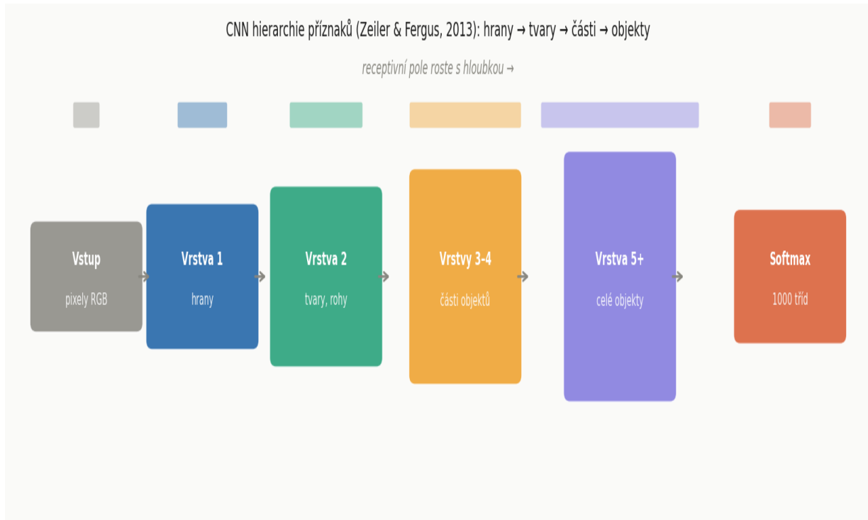
Obr. 4 — CNN hierarchie příznaků (Zeiler & Fergus, 2013): V1=orientované hrany, V2=rohly a textury, V3-4=části objektů, V5+=celé objekty. Receptivní pole roste s hloubkou.
