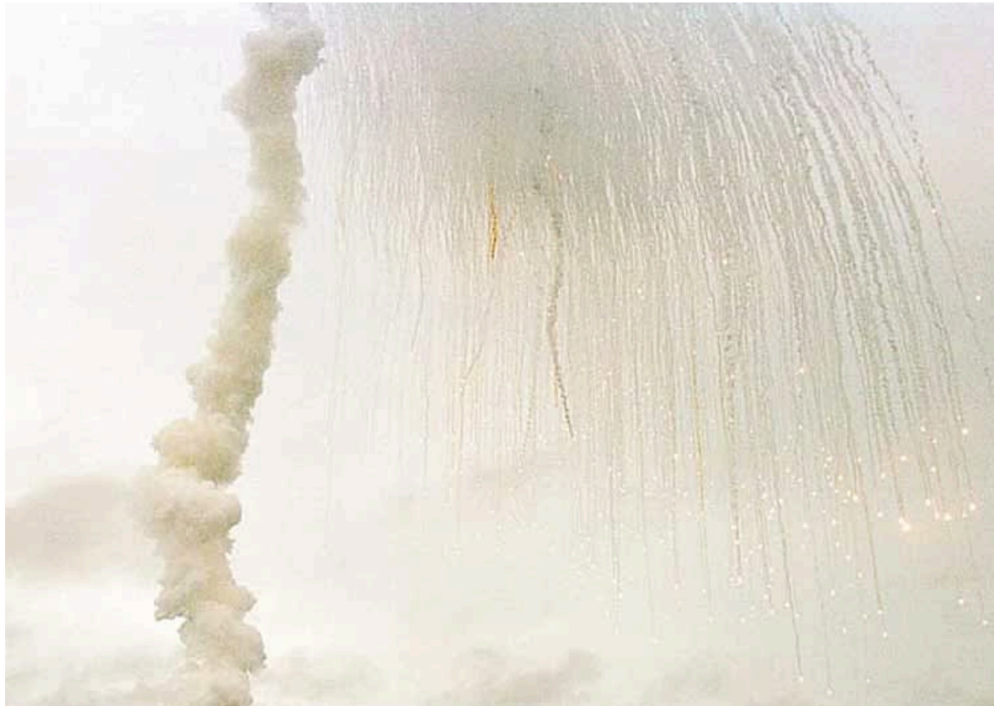
Obr. VI.6 — Ariane 5 při letu V88 (4. 6. 1996): autodestrukce 37 sekund po startu kvůli integer overflow v guidance softwaru.
