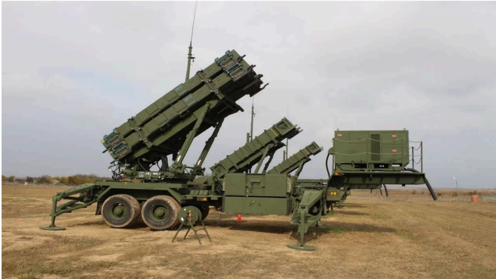
Obr. VI.5 — Raketový systém Patriot. Systém počítal čas v 24-bit fixed-point registru s konstantou 0,1, která má nekonečný binární rozvoj.
